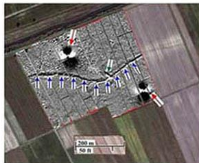
Nella mappa magnetica le frecce rosse indicano due intense anomalie prodotte dai tralicci della linea ad alta tensione, le frecce blu indicano il paleoalveo o meglio la sua immagine magnetica (anomalia magnetica).
