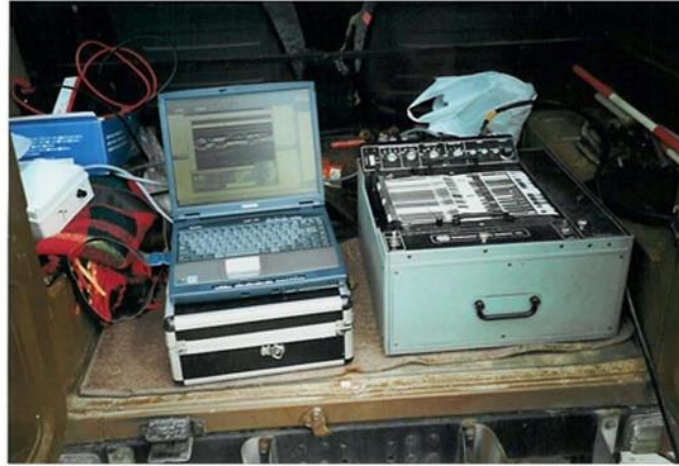
Radar SIR 3 analogico-digitale
