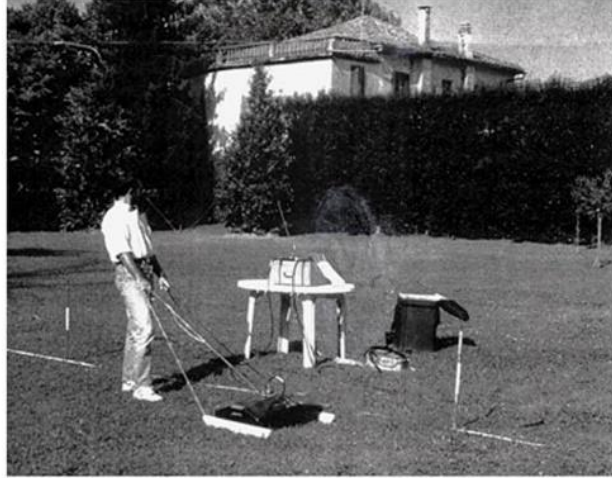
Radar SIR 3 (analogico)
