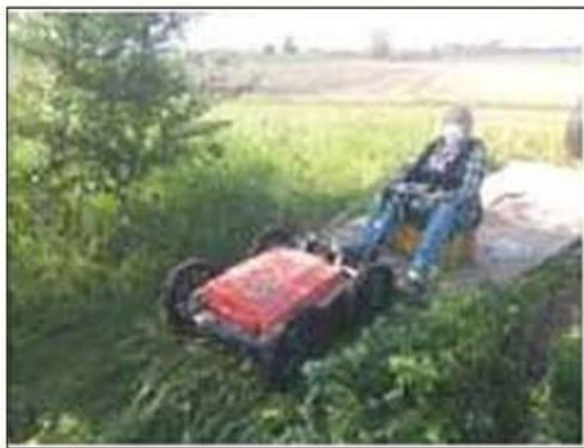
Indagine georadar in corso
