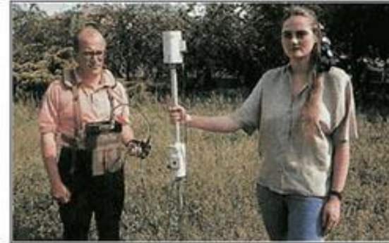
Magnetometro a protoni G856 in configurazione "gradiometro"
