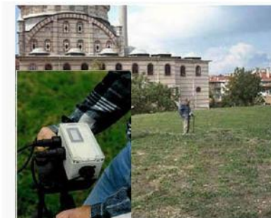
Indagine geoelettrica in corso con l'uso del resistivimetro RM4
