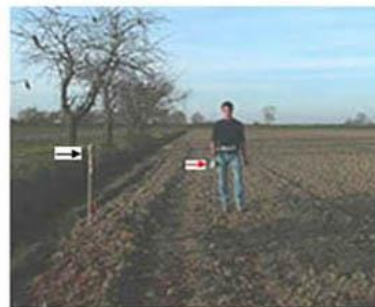
Indagine magnetica in corso con l'uso del magnetometro al cesio G858. La freccia rossa indica il sensore del G858 itinerante sul campo, la freccia nera indica il sensore del magnetometro a protoni G856 fermo alla stazione base.
