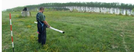
Foto 5: Indagine con elettromagnetometro EM31 utilizzato in Discarica Sabar anche per verificare-collaudo le coperture definitive dei bacini esauriti.
