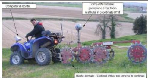
Attraverso questo sistema a ruote dentate pensato per l'indagine geoelettrica estensiva del primo sottosuolo, si realizza una mappatura sia in senso laterale che verticale delle proprietà elettriche del suolo. Si raccolgono dati a tre profondità diverse, fino a 170 cm dal piano campagna.
