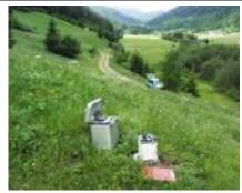
Le indagini microgravimetriche sono sempre più affiancate a indagini sismiche attive e passive (H/V) per la dell'assetto caratterizzazione sepolto (andamento del basamento delle roccioso), strutture geologiche geomorfologiche (geometria di un conoide alluvionale).
